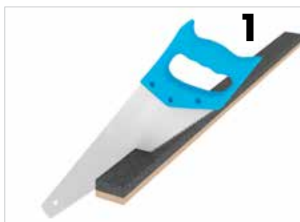
1. Isoleringsstolpen tilskæres med en fintandet sav.
